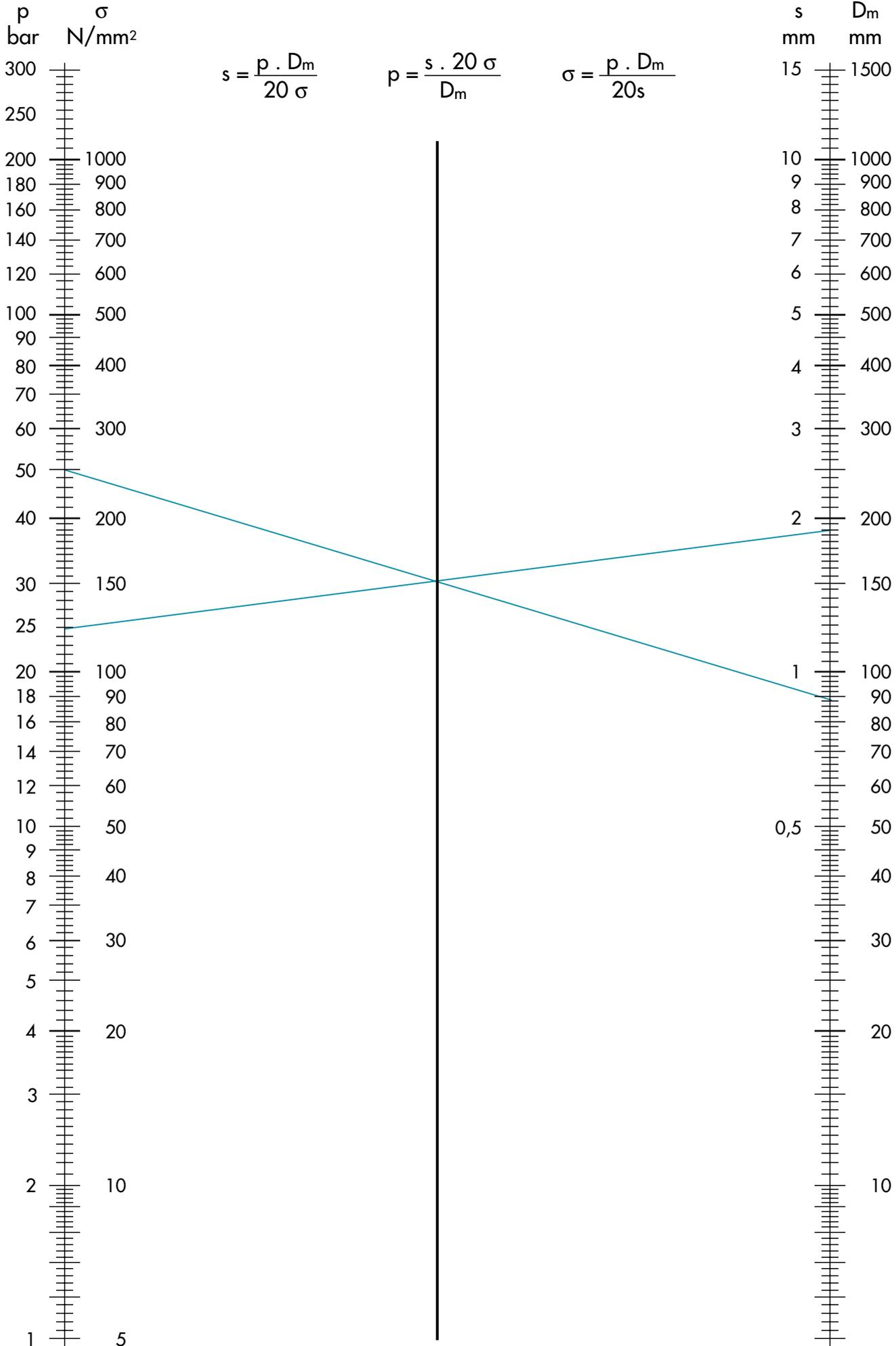
Nomogram se uporablja za preračunavanje odvisnosti med tlakom, dimenzijo in obremenitvijo cevi glede na dane postavke.
